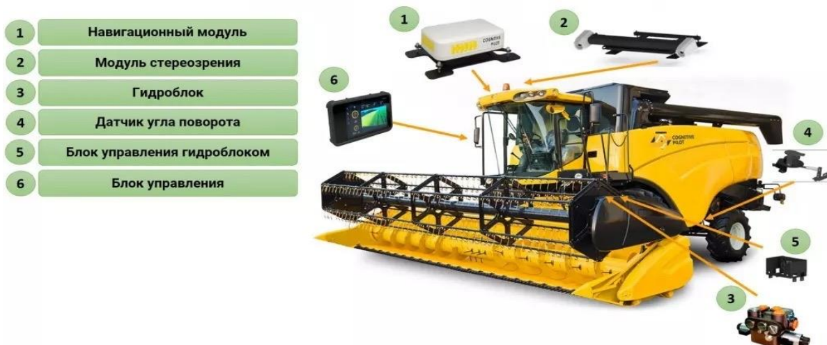
Рисунок 2. Система автономного управления сельскохозяйственной техникой Cognitive Agro Pilot.
